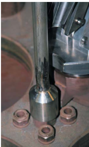
Eingeführte Messlanze (Test im GK Tullnerfeld)
