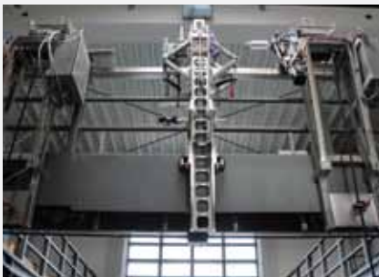
Eine Hilfsbrücke, die sich an Hilfsbrücken deutscher Kernkraftwerke orientiert, erlaubt realistische Kalthandhabungen.
